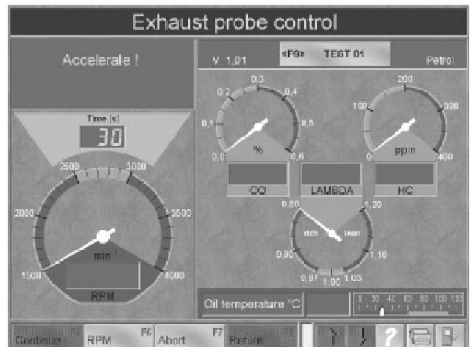
Hình 8.38 : Màn hình hiển thị kiểm tra đầu dò khí thải
